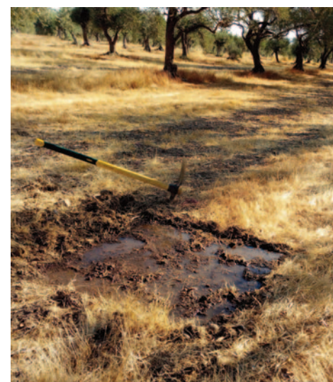
Testez l'infiltration : d'élimitez un carré de 1 m 2 , versez un arrosoir de 10 l, l'eau doit s'infiltrer sans aucun délai, ni ruisseler à la surface. Sur cet exemple il a fallu plus d'une minute pour que l'eau pénètre, la décompaction est indispensable.
