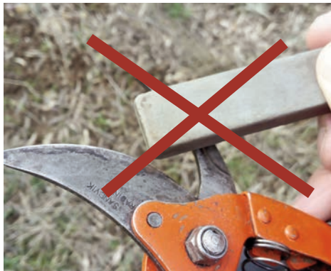
Attention la contre-lame ne doit jamais être affûtée. En revanche elle doit être tenue propre.
